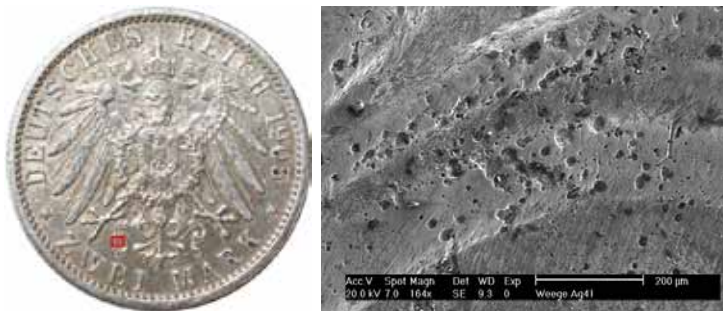
Abb. 5: Gegossene Fälschung von 2 Reichsmark von 1905. Rechts Rasterelektronenmikroskopaufnahme (REM) der rot markierten Umrandung. Deutlich sind die Gussporen erkennbar. Diese senken die LFK der Münze auf unter 30 MS/m. Originale geprägte 2 RM und 5 RM Münzen weisen dagegen eine LFK i.d.R. von 37-45 MS/m auf. In diesem Fall lässt sich der Guss also mittels LFK leicht erkennen. Ein Vergleich mit Werten aus dem Buch „Weege 2 – Münzfälschungen Deutsches Kaiserreich“ verschafft hier schnell Klarheit.
